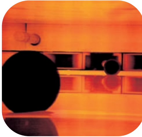
Blick in das Zinnbad: Toproller regulieren die Glasdicke.
